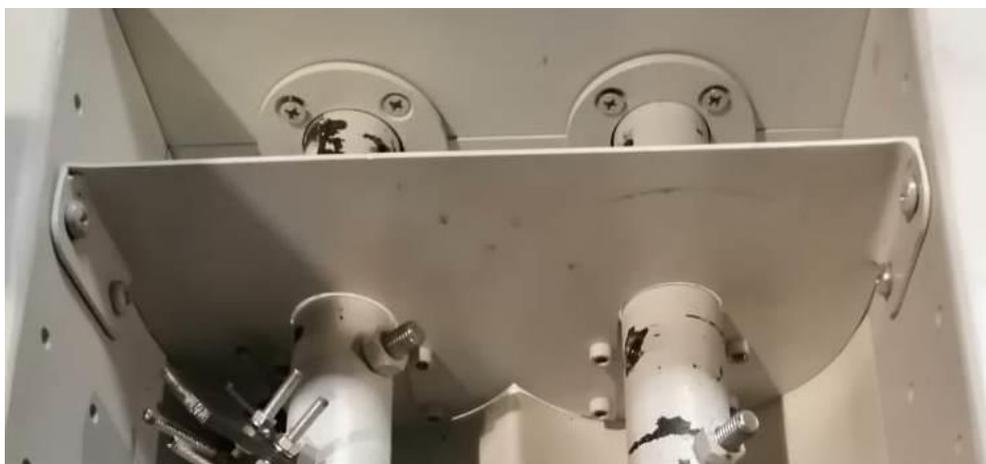
Рисунок 3.3. Съёмная перегородка для обеспечения работы смесителя в периодическом режиме
