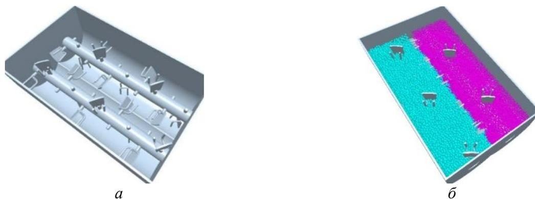
Рисунок 2.4. Цифровые модели корпуса лопастных смесителей:
