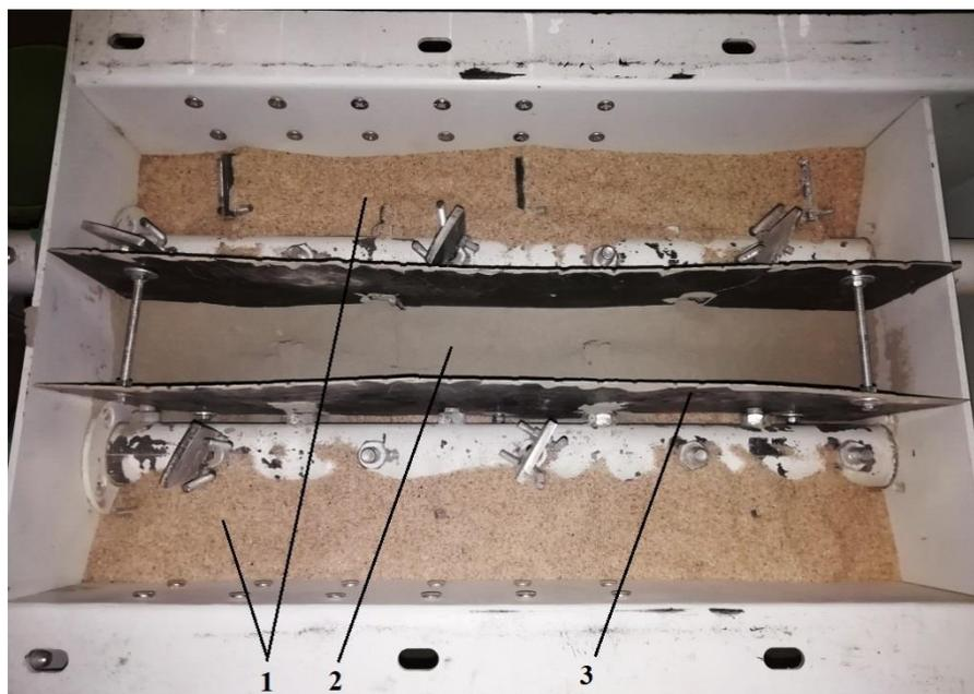
Рисунок 4.7. Рабочая камера смесителя с перегородкой:
