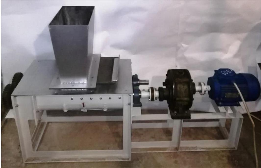
Рисунок 3.1. Экспериментальная установка двухвального смесителя с установленными стержневыми элементами
